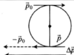
5. Абсолютно упругое отражение от горизонтальной поверхности — модули конечной и начальной скоростей равны:  $v = v_0, p = p_0$ ; угол падения равен углу отражения
