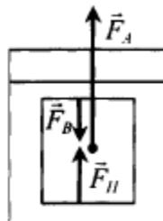
Причина возникновения выталкивающей силы: нижняя грань тела находится на большей глубине, чем верхняя, поэтому давление жидкости снизу больше, чем сверху. Из-за разницы в давлениях возникает выталкивающая сила.
