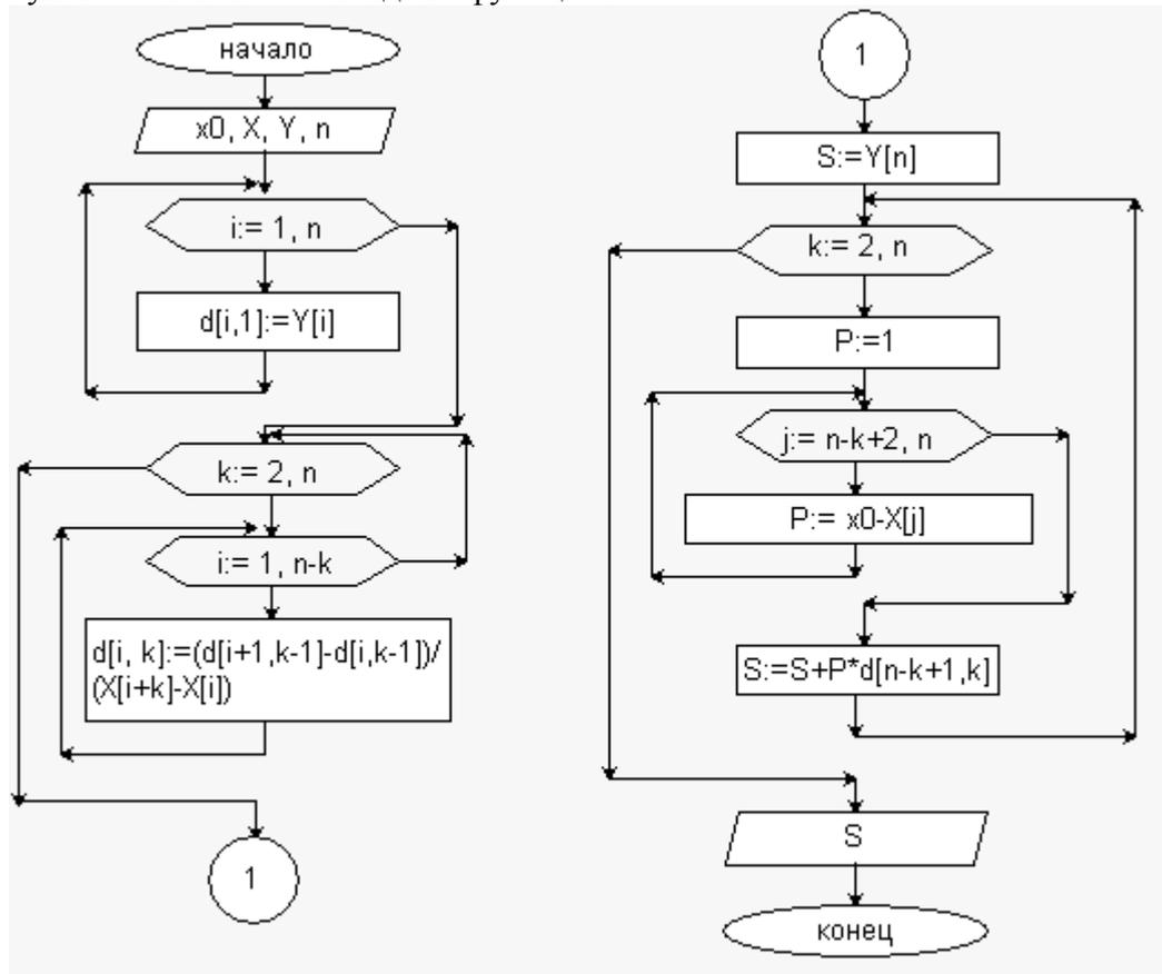
По заданным узловым значениям исходной функции (векторы  $X$  и  $Y$ ) запишем **СЛАУ для расчета коэффициентов кубического сплайна** со свободным закреплением концов.
