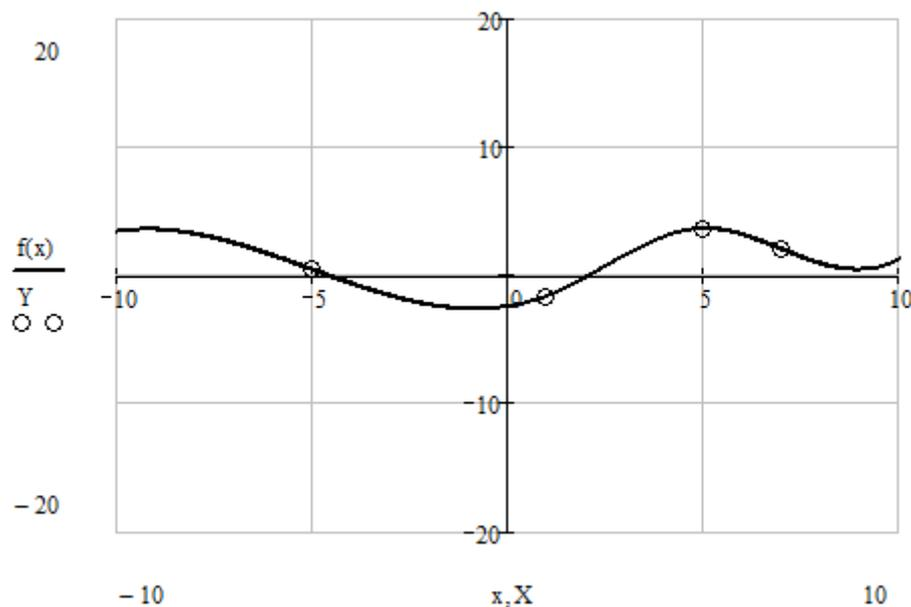
По заданным узловым значениям исходной функции (векторы  $X$  и  $Y$ ) методом наименьших квадратов определим *коэффициенты аппроксимирующего обобщенного многочлена*  $Pm(x) = \sum_{k=0}^m a_k \varphi_k(x)$ , где  $\varphi_k(x)$  - система базисных функций (в задании даны степенные функции). Согласно метода наименьших квадратов коэффициенты  $a_k$  определяются из условия
