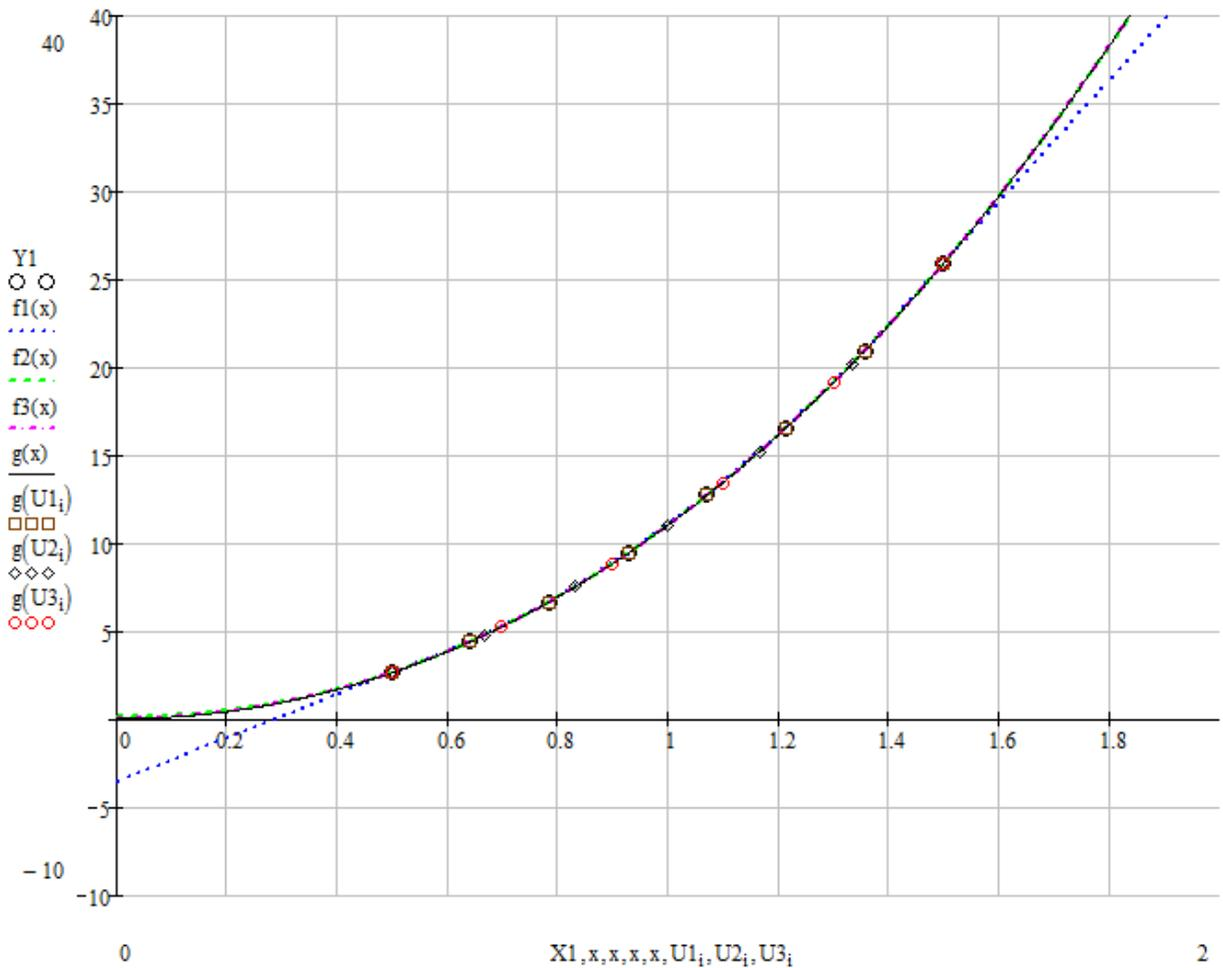
в) По узловым значениям (векторы  $X1$  и  $Y1$ ) реализуем в MathCAD линейную аппроксимацию (функции *line*, *medfit*), полиномиальную аппроксимацию (функции *regress* (в задании даны степени аппроксимирующих полиномов) и *loess* (параметр *span* выбрать самостоятельно)), аппроксимацию функциями специального вида (в задании указана одна из функций *expfit*, *lgsfit*, *sinfit*, *pwfite*, *logfit*, ***lnfit***).
